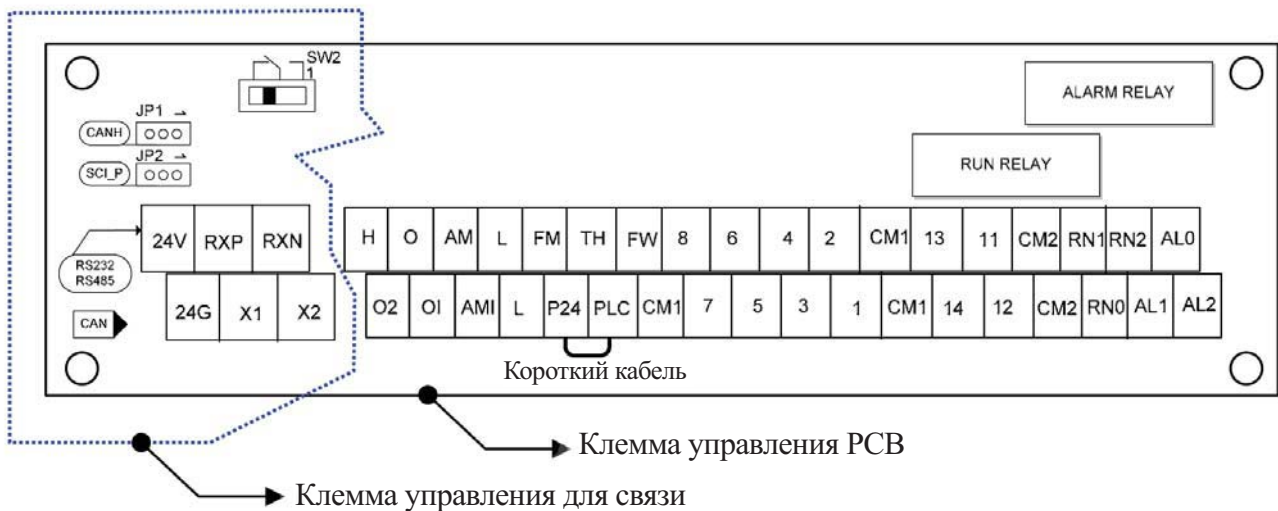
Рис. 13-2 Спецификация порта RS485 (Клемма управления РСВ)
